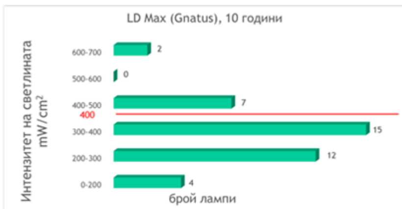
Фиг. 13. Измерване на светлинния интензитет на LD Max (Gnatus) след 10г. употреба
