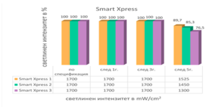
Фиг. 12. Промяна на светлинния интензитет на ФПЛ Smart Xpress (Blue dent) за 5 годишен период на употреба.
