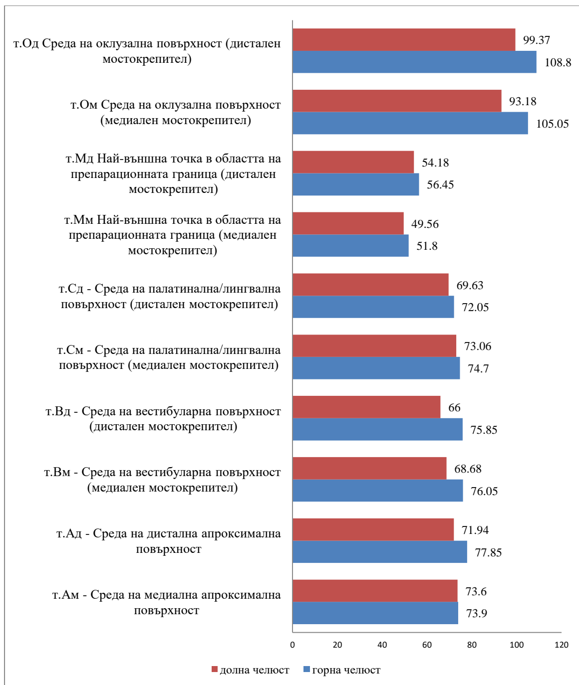
Фиг.36. Сравнителен анализ на средните стойности на отстоянието, измерено чрез силиконова проба с CAD софтуер при изработените по ДОТ конструкции според вида на протезираната челюст (μm)
