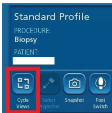
Фиг. 52.** Задължително опресняване на екрана при всяка интервенция с цел предпазване от проява на аномалия в софтуера свързана с нарушаване на синхронизацията на дълбокомера с останалата навигационна информация (BVM StealthStation 2021).
