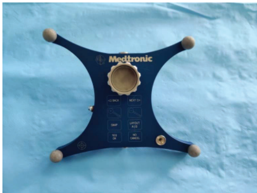
Фиг. 4.* Референтна рамка (reference frame).
