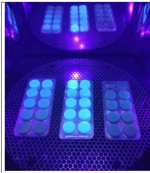
Фиг. 15. Светлинна полимеризация на тестовите образци във аппарата Form Cure®.
